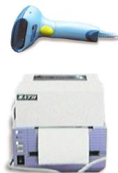
Sistema di gestione dei componenti e dei caricatori mediante Bar Code. Esso previene possibili errori di posizionamento. Include la stampante per le etichette.
